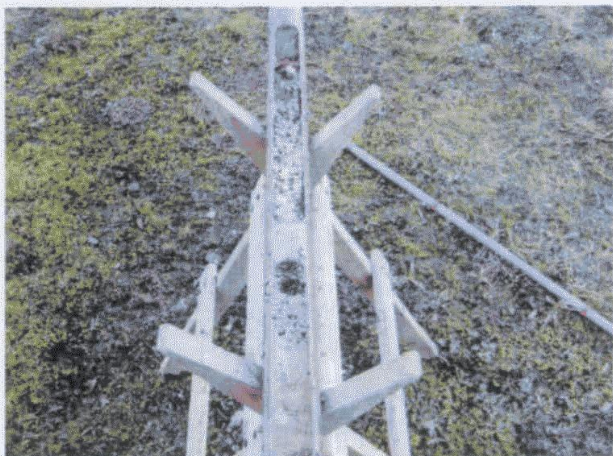
Bild 2: Bohrprofil S3, 0,00-1,00 m: schwermetallhaltiger, schwar- zer Splitt unter Schotterge- misch in 0,50-0,60m
