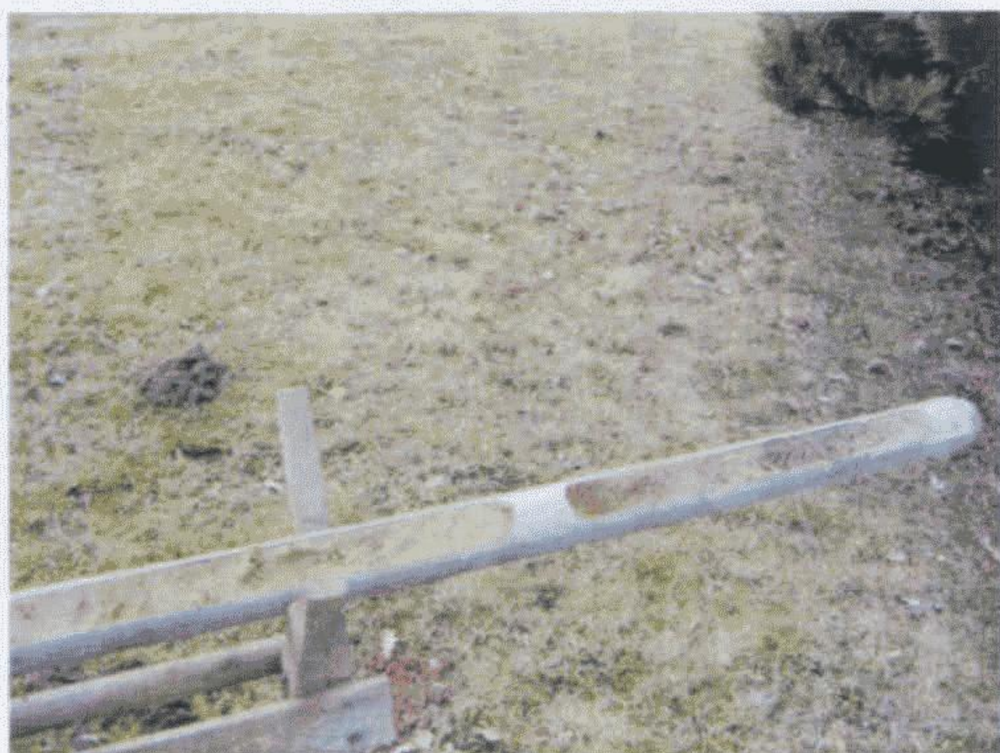
Bild 9: Bohrprofil S37, 2,00-3,00 m: fleckig sehr hellbrauner/beiger, feinsandiger Mittelsand (links) über stark feuchtem, hellgrauem, grobsandigem Mittelsand; das Profil ist vermutlich der Oberterrasse zuzuordnen
