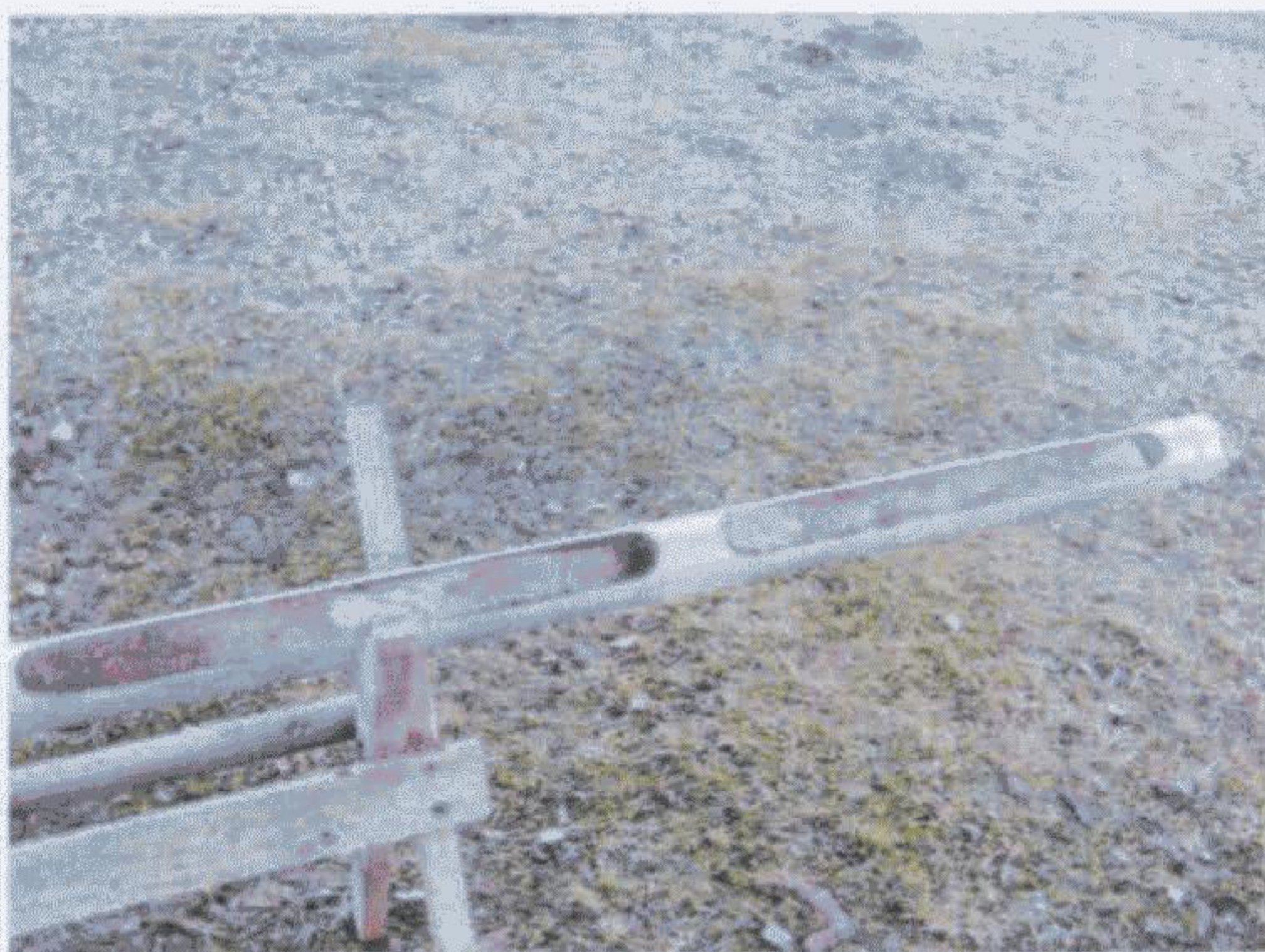
Bild 7: Bohrprofil S25, 2,00-3,00 m (Anschlussprofil zu Bild 6): feinsandiger Mittelsand mit Übergang von schwarzer Verfärbung nach dunkelbraun und schließlich fleckig hellbraun/braun (von links nach rechts); im Liegenden (rechts) hellgrau/rotviolett gebänderter toniger Schluff
