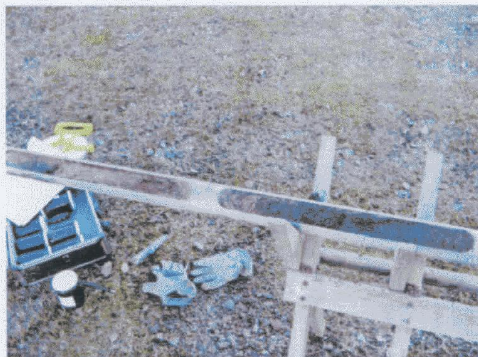
Bild 6: Bohrprofil S25, 1,00-2,00m: fleckig hellbrauner/brauner/graubrauner Mittelsand (links) über schwarz verfärbtem, feinsandigem Mittelsand
